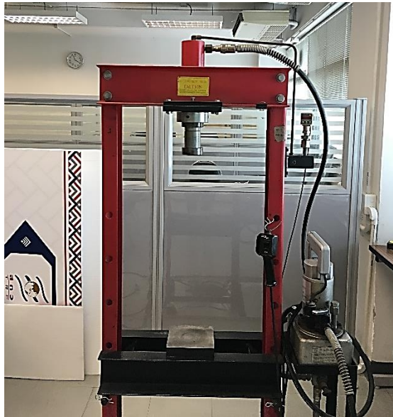
รูปแสดงชุดแม่พิมพ์ขึ้นรูป ส่วนที่ 2 ชุดเครื่องอัดขึ้นรูปพลาสติก
