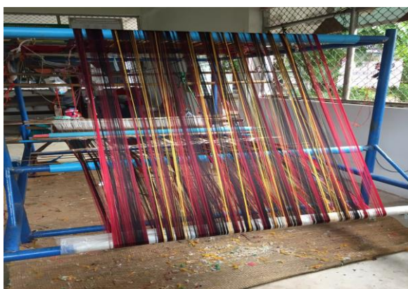
ภาพที่ 2 หูกสำหรับการทอผ้าไหมพื้นเมืองบ้านปะอ่าว
