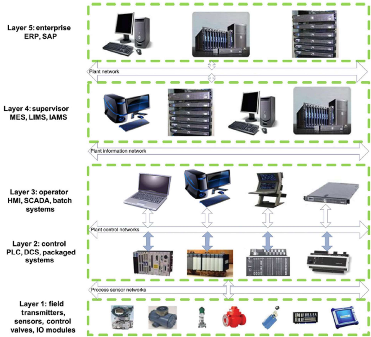
รูปที่ 2.2 รูปแบบการเชื่อมต่อแต่ละระดับชั้นของระบบอัตโนมัติ
