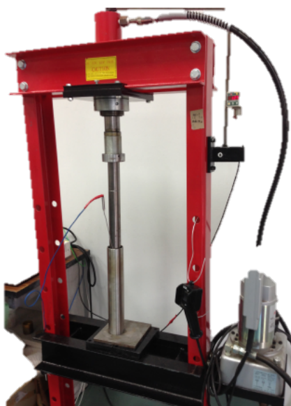
รูปที่ 2.4 ชุดทดลองการผลิตถ่านชีวภาพในแนวตั้ง
