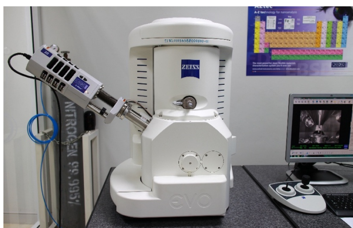
รูปที่ 3.11 กล้องจุลทรรศน์อิเล็กตรอนแบบส่องกวาด (SEM, Zeiss EVO MA10)
