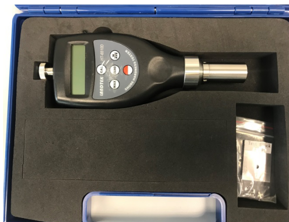
รูปที่ 3.10 เครื่องทดสอบความแข็ง Hardness Tester Shore D
