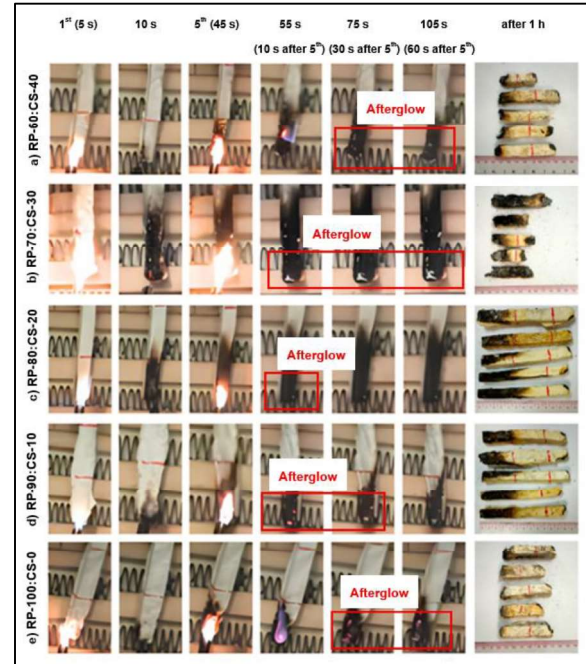
รูปที่ III. พฤติกรรมการหน่วงไฟของ MBC ขณะและหลังทดสอบ VB Test ตามมาตรฐาน UL-94
